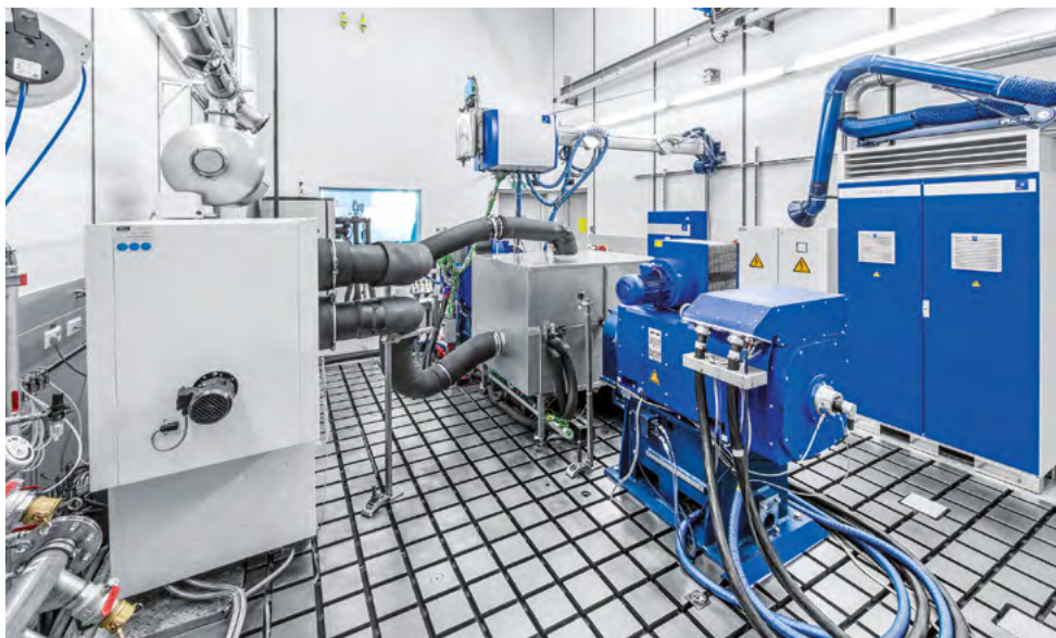
Prüfstand für elektrische Antriebe, Foto: AVL List GmbH
