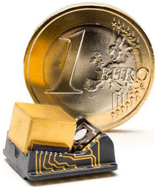
Die laserbasierte Mikroprojektionseinheit „Trixel“ von TriLite Technologies
